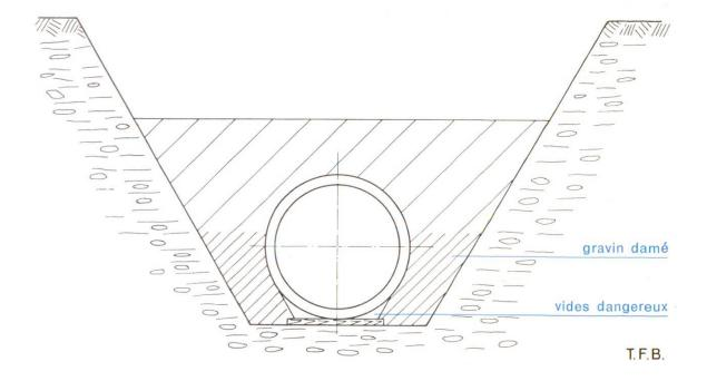
Fig. 1 Tuyaux mai posés dans une fouille en V. Le damage du gravier n'évite pas les vides dangereux.
