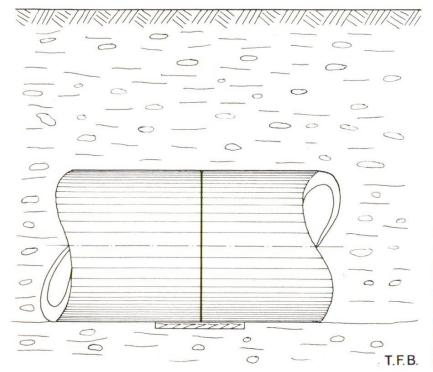
Fig. 2 Lestuyaux qui ne reposent que sur quelques points (planchettes) sont soumis à des efforts concentrés. Ceci peut y provoquer des ruptures, surtout si la fouille est remblayée et compactée mécaniquement.
