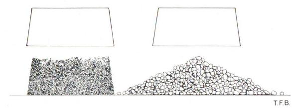
Fig. 3 Un effet de surface: le sable humide a une cohésion, le gravier, même humide, aucune.
