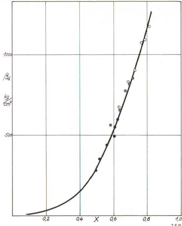
Fig. 4 Relation entre la résistance à la compression sur cube  $\beta d$  etl a proportion de gel dans le volume disponible (X). Les différents points se rapportent à trois mortiers différents. Le fait qu'ils se trouvent sur la même courbe indique bien qu'il s'agit d'une relation très générale (selon T. C. Powers).
