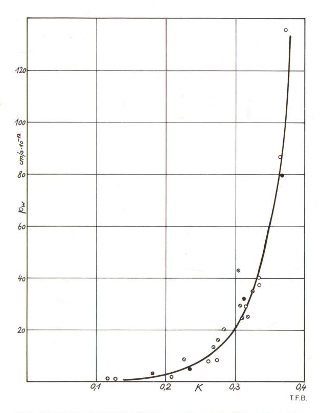
Fig. 5 Relation entre la perméabilité (Pw) et la porosité capillaire (K) de la pâte de cimen durcie. Les points blancs et noirs concernent des pâtes préparées avec des ciments de finesses différentes et essayés à des âges différents. Points blancs: surface spécifique du ciment 3400 cm²/g, essais à 233 et 416 jours. Points noirs: surface spécifique du ciment: 7800 cm²/g, essais à 325 jours (selon T. C. Powers).
