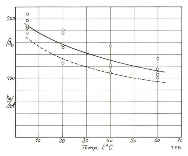
Fig. 3 Influence de la température lors de l'essai sur la résistance à la flexion βb de la pâte de ciment durcie. Ligne pleine supérieure: conservation 3 mois dans l'eau à 40 °C; ligne pointillée inférieure: conservation 6 mois dans l'eau à 20 °C. Essais après que les éprouvettes aient été placées 6 h. dans l'eau à t °C (selon G. Wischers).
