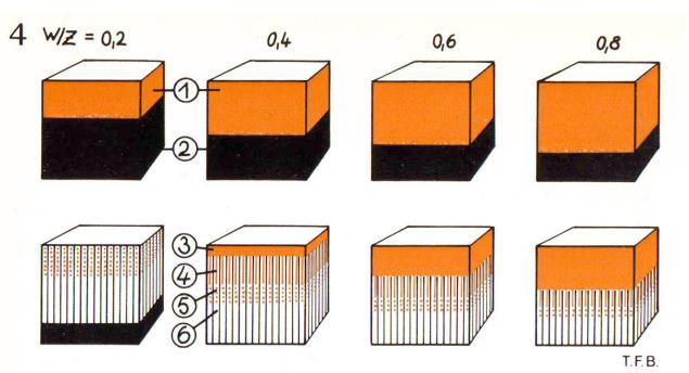
Fig. 2 Répartition des volumes à l'intérieure de la pâte de ciment à l'état frais et après un certain degré d'hydratation, pour des facteurs eau/ciment de 0,2; 0,4; 0,6 et 0,8. 1. Eau de gâchage; 2. ciment; 3. eau inutile = volume des pores capillaires; 4. eau fixée dans les pores du gel; 5. eau fixée chimiquement; 6. volume spécifique de la pâte durcie (hachures verticales). Pour e/c = 0,2, la quantité d'eau est insuffisante, il reste du ciment non hydraté.
