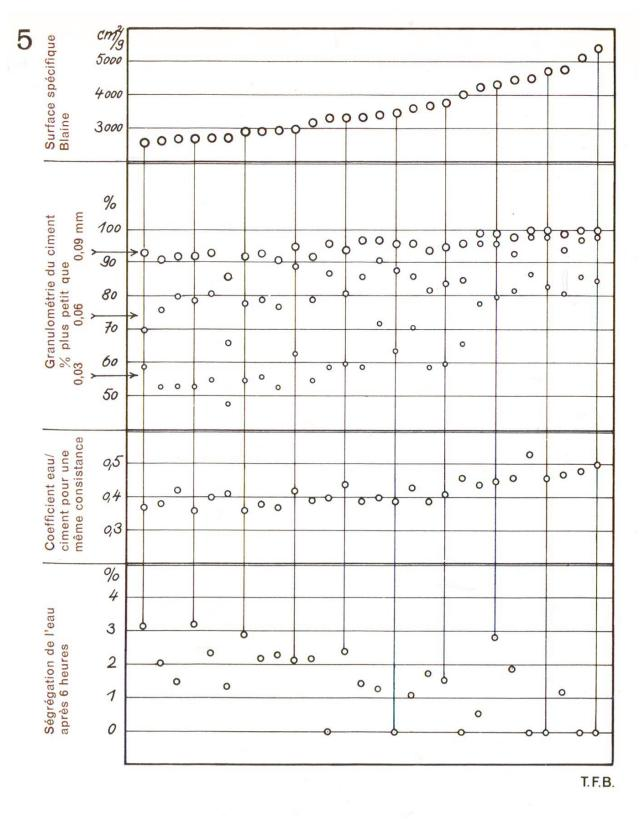
Fig. 3 Influence de la finesse de mouture du ciment sur le besoin en eau et le ressuage de la pâte de ciment. (Selon K. Walz et H. Mathieu, Der Einfluss des Zementes auf die Eigenschaften von Zementsuspensionen, Betontechnische Berichte 1961, Betonverlag, Düsseldorf).
