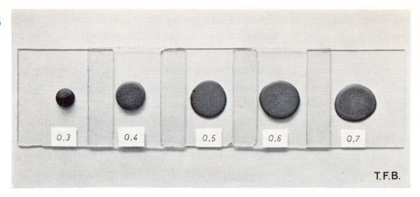
Fig. 1 Essai simple pour comparer la fluidité de pâtes de ciment ayant différents facteurs eau/ciment. On remarquera le passage brusque des états pâteux à liquide pour un e/c=0,4.
