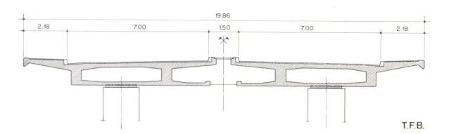
Fig. 2 Coupe transversale type du viaduc d'Altstetten.
