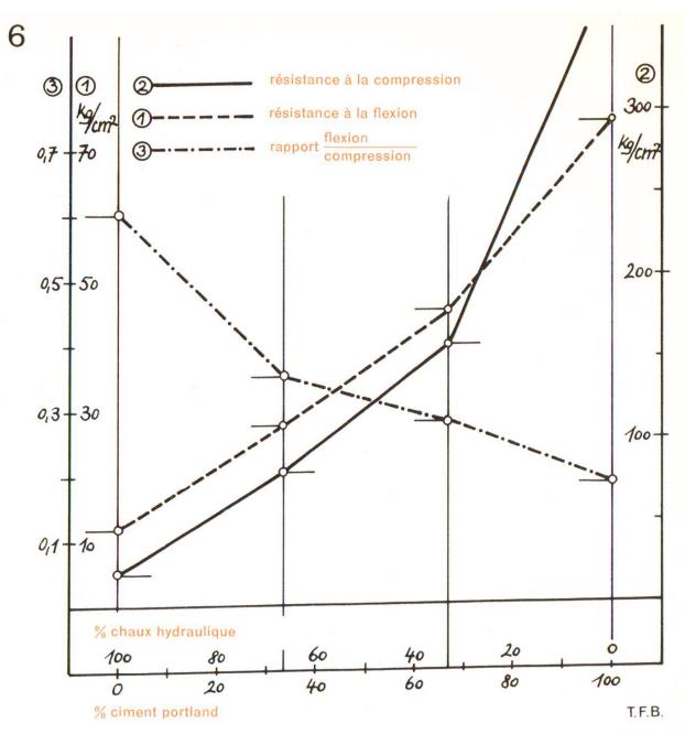
Fig. 3 Résistances de mortiers de chaux hydraulique améliorée, en fonction de la proportion de ciment ajoutée. Dosage total: 400 kg/m³. On a reporté également le rapport des résistances à la flexion et à la compression qui croît avec la proportion de chaux.
