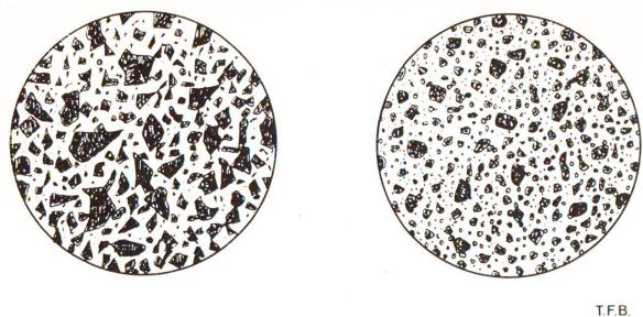
Fig. 1 A gauche, grains de ciment, à droite, grains de chaux hydraulique, tels qu'on les verrait au microscope. Grossissement 120 fois.
