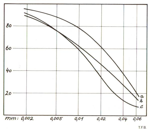
Fig. 2 Courbes granulométriques de la chaux hydraulique (courbes b et c) comparées à celle du ciment portland (courbe a).
