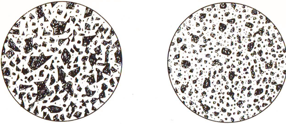
Fig. 1 A gauche, grains de ciment, à droite, grains de chaux hydraulique, tels qu'on les verrait au microscope. Grossissement 120 fois.
