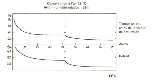
Fig. 2 Desséchement et retrait d'un béton relativement maigre et poreux. Conservation dans l'air, premièrement à 70% puis à 25% d'humidité relative. On remarque qu'il s'établit toujours un état d'équilibre entre la teneur en eau du béton et l'humidité de l'air (selon Kalousek).
