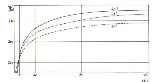
Fig. 4 Résistances d'un béton soumis pendant les premières heures aux températures indiquées, puis conservé à 21 °C. P 360, E/C=0,52 (selon Price).
