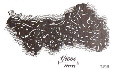
Fig. 3 Pores capillaires dans la pâte de ciment durcie
