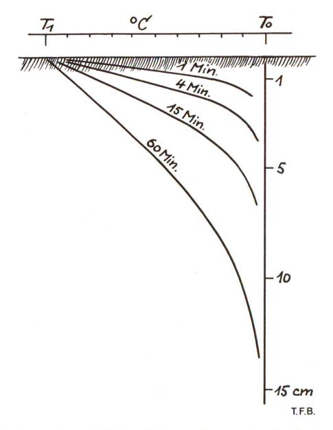
Fig. 4 Répartition des températures à l'intérieur du béton après un certain nombre de minutes, quand la température extérieure est descendue de T0 à T1 (selon Joisel)
