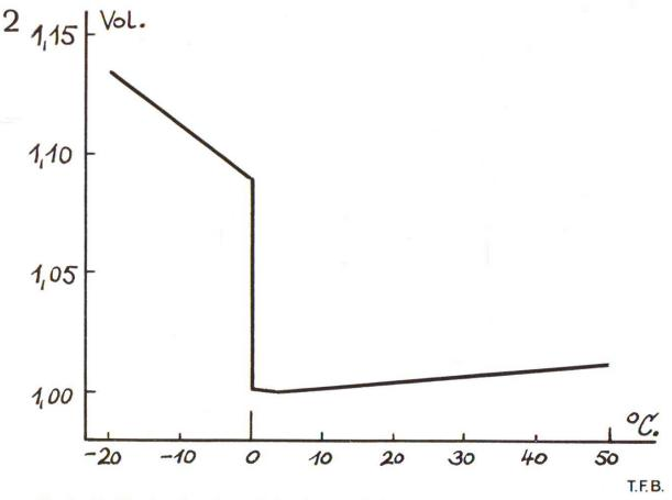
Fig. 1 Modification du volume de la glace ou de l'eau en fonction de la température
