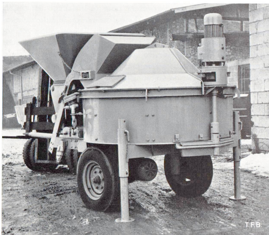
Fig. 2 Turbomalaxeur avec benne élévatrice. On remarque à droite le dispositif (avec moteur électrique) d'ouverture d'un segment du fond de la cuve pour la vidange
