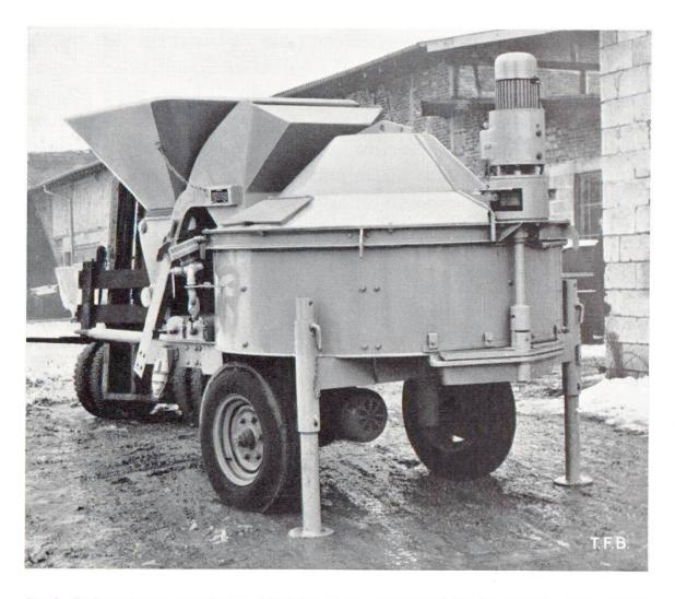
Fig. 2 Turbomalaxeur avec benne élévatrice. On remarque à droite le dispositif (avec moteur électrique) d'ouverture d'un segment du fond de la cuve pour la vidange
