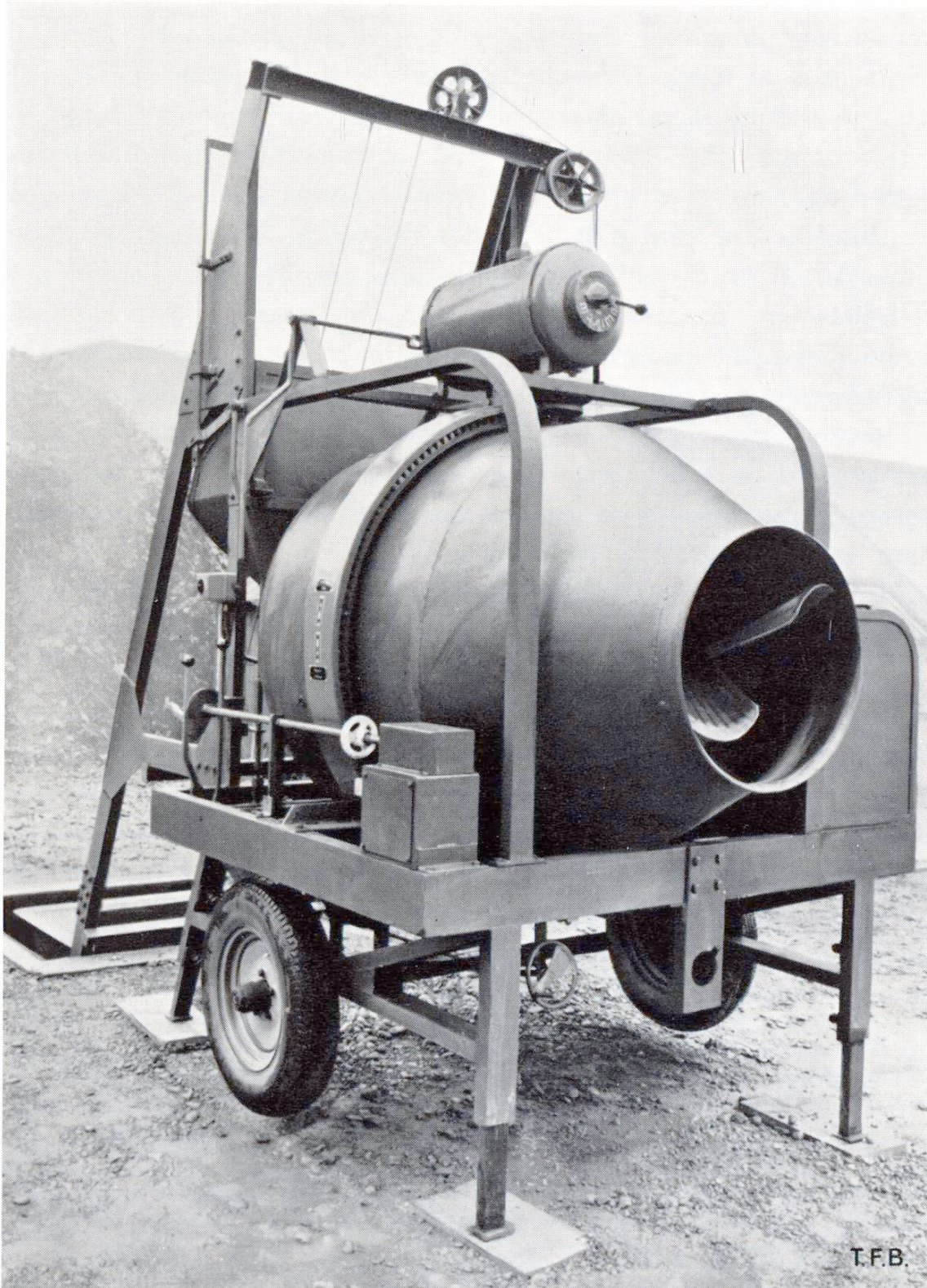
Fig. 3 Bétonnière à chute libre pour un petit chantier. Vidange par inversion du mouvement de rotation du tambour
