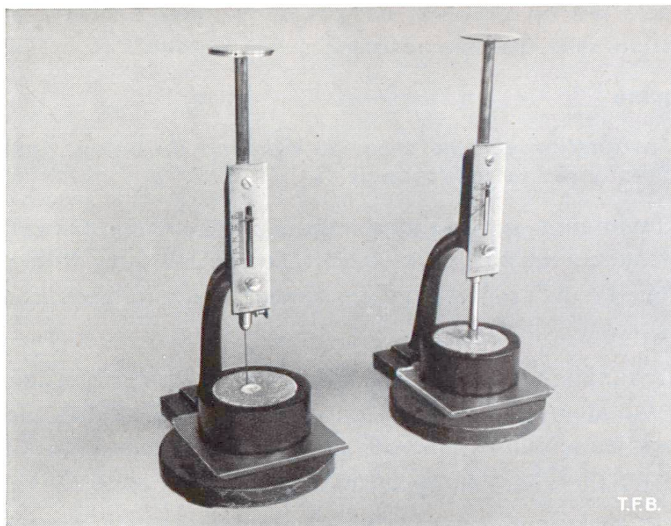
Fig. 2 Appareil de Vicat pour la détermination du temps de prise. A droite: avec dispositif pour contrôler la consistance convenable de la pâte de ciment. A gauche: avec aiguille permettant de déterminer les enfoncements lors du début et de la fin de prise
