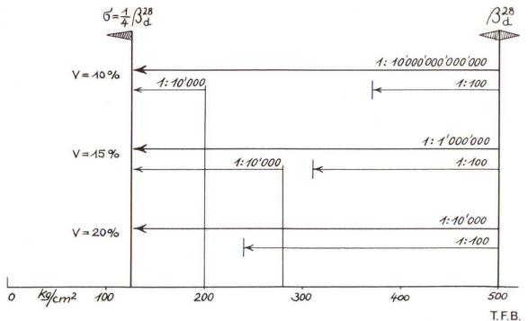
Fig. 4 Rapport entre la contrainte admissible  $\sigma$ ; et la résistance moyenne à la compression  $\beta_d^{28}$  pour différents coefficients de variation V. Béton spécial de résistance moyenne à la compression de 500 kg/cm² à 28 jours. V = 10, 15, et 20 %. Les rapports indiqués (p. ex. 1:10 000) montrent avec quelle probabilité la résistance du béton considéré atteindra la limite indiquée ou la contrainte admissible
