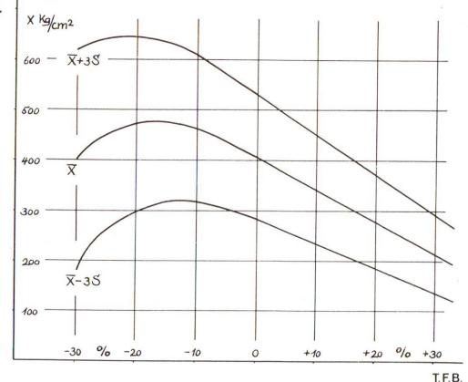
Fig. 2 Variations de la résistance moyenne à la compression du béton dues à des erreurs de mesure de la quantité d'eau ( $\pm$  % eau). Domaine de variation limité par le triple de l'erreur quadratique moyenne ( $\pm$  3 S); le 99,7 % de tous les résultats se trouvent dans ce domaine selon Vironnaud (Bibl. 1)
