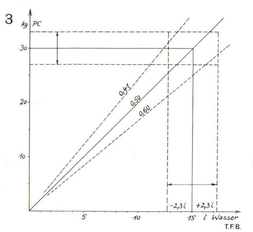
Fig. 1 Domaine de variation des quantités de ciment et d'eau et du facteur eau : ciment pour 100 mélanges de 100 litres. Pesage du ciment et compteur d'eau, sans contrôles particuliers. Coefficient de variation des résistances à la compression à 28 jours,  $V=15\,\%$
