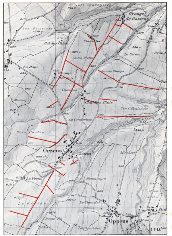
Fig. 11 Exemple de l'aménagement du réseau de chemins agricoles d'une commune non loin d'Yverdon. En rouge: env. 55 000 m² de chemins en béton. (Reproduction autorisée par le Service topographique fédéral, 12. 5. 1960)
