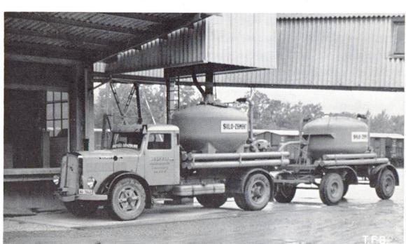
Fig. 5 Chargement de ciment en vrac sur camion placé sur pont-bascule
