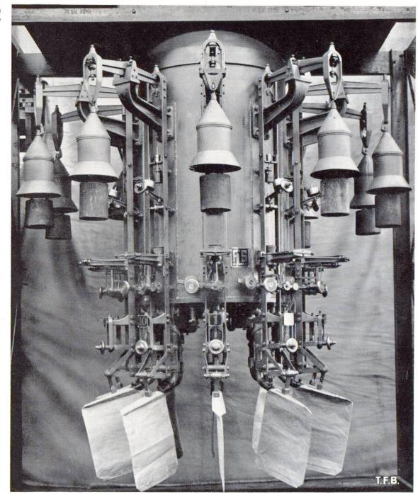
Fig. 2 Ensacheuse tournante
