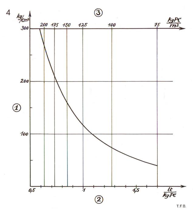
Béton à la consistance terre humide ayant une teneur en eau de 5,5 % du poids des matériaux secs. Résistances à la compression à 28 jours (1) en fonction du facteur eau / ciment (2) et du dosage en ciment (3). (D'après L. S. Blake, The Surveyor [London], 117, 484 [May 1958])
