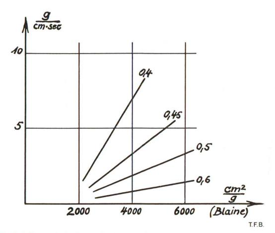
Fig. 2 Influence de la finesse du ciment sur la viscosité d'un mortier de ciment pur de facteur eau/ciment de 0,4 à 0,6 (selon Papadakis)
