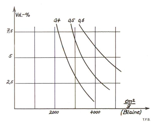
Fig. 3 Influence de la finesse du ciment sur le ressuage d'un mortier de ciment pur pour des facteurs eau/ciment de 0,4 à 0,6 (selon Papadakis, volume d'eau ressuée après 2 heures, en 0/0, pour une couche de mortier de 10 cm de haut)
