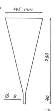
Fig. 1 Exemple d'un entonnoir pour la détermination de l'aptitude d'un mortier à couler. On mesure le temps nécessaire à l'écoulement de 1 litre de mortier (selon Papadakis)
