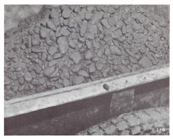
Fig. 2 Légère ségrégation d'un béton frais à la sortie d'une bétonnière. C'est là qu'il est le plus facile d'observer le comportement du béton à cet égard
