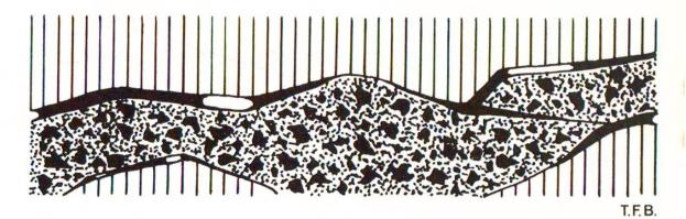
Fig. 5 Adhérence par les forces capillaires qui prennent naissance quand de minces interstices entre deux corps sont remplis d'eau ou de solution acqueuse.
