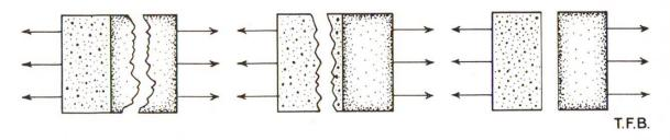
Fig. 2 Les trois possibilités de rupture d'un assemblage de deux corps.
