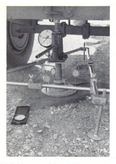
Fig. 3 Mesure de la portance de la fondation au moyen de l'appareil VSS
