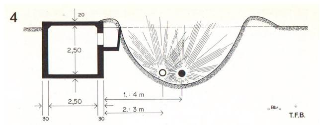
Fig. 3 Essai d'explosion au voisinage d'un abri en forme de boîte en béton armé. Armature croisée, fer  $\varnothing$  10 mm, écartement 30 cm à la face extérieure et 15 cm à la face intérieure. 1: explosion à 4 m, 2: explosion à 3 m
