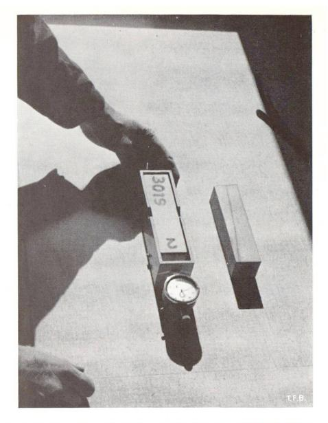
Fig. 4 Mesures de retrait sur des prismes de mortier normal selon une méthode simplifiée mise au point par le T, F. B.
