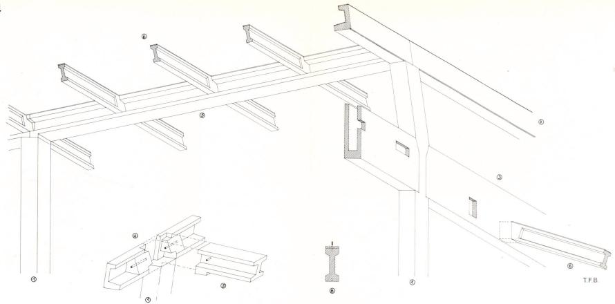
Fig. 4 Détails de la construction. Les entraits inférieurs ont été remplis de béton après la pose des pannes.
