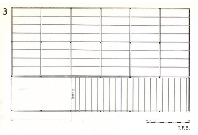
Fig. 2 Vue en plan avec le système de fermes et de pannes.
