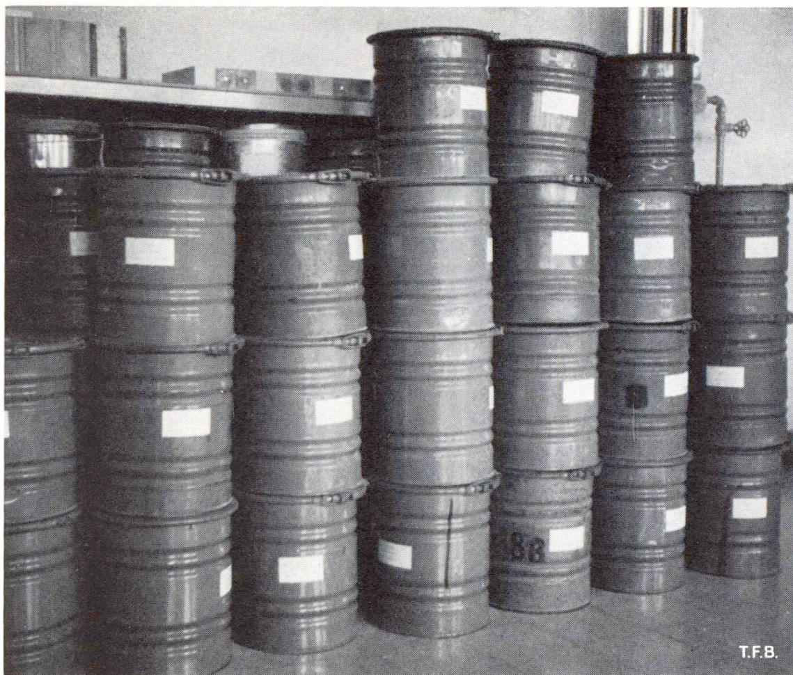
Fig. 4 Boîtes pour les échantillons de ciment en vrac. Contenance 10—15 kg
