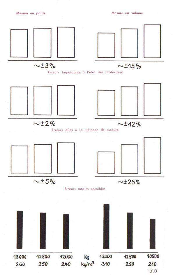
Variation de la consommation de ciment résultant des erreurs de mesure des quantités d'agrégats (calculées pour 50 m³ de béton CP 250)
