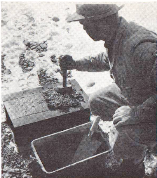
Fig. 5 Damage à la massette
