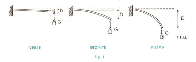
Ce phénomène peut être représenté graphiquement en portant en abscisse les charges et en ordonnée les déformations. C'est le diagramme charge-déformation.
