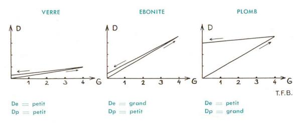
Fig. 2 Trois diagrammes charge-déformation représentés schématiquement
