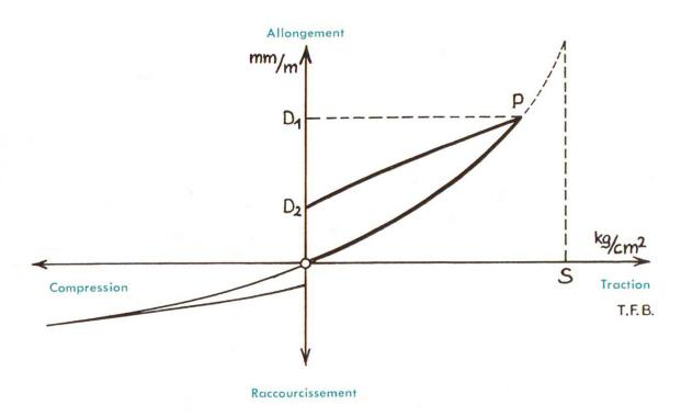
Fig. 3 Représentation schématique du diagramme charge-déformation d'un béton
