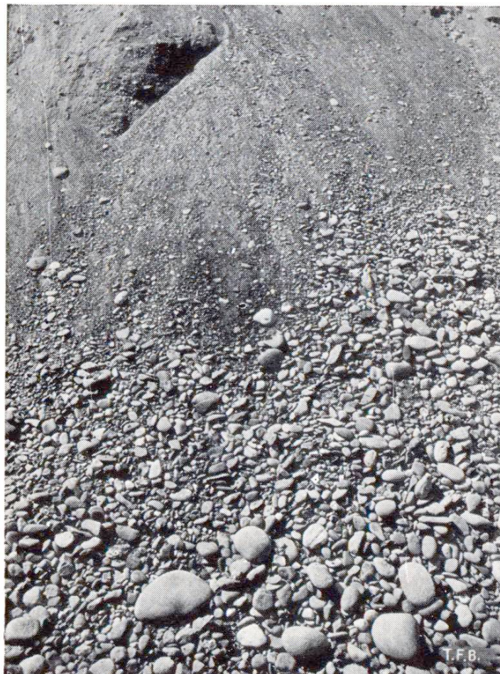
Fig. 4 Démélange dans un tas de sable et gravier
