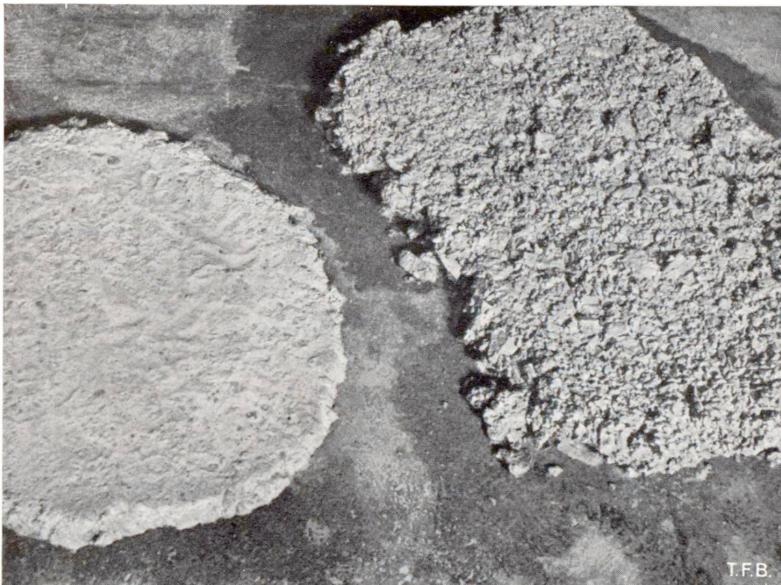
Fig. 2 Ces deux mélanges, l'un mou (à gauche) et l'autre dur (à droite) ne s'étalent pas de la même façon. La différence est visible à la surface de l'échantillon et à la forme de son contour.
