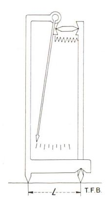
Fig. 3 Appareil avec double système de leviers. De très petites variations de la longueur L sont amplifiées fortement et indiquées par l'aiguille
