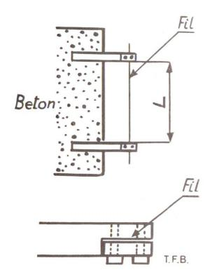
Fig. 5 Mesure des variations de longueur au moyen d'un fil d'acier tendu entre deux points du béton à observer. De petites modifications de la tension du fil entrainent des changements de vibrations qui sont mesurées électriquement
