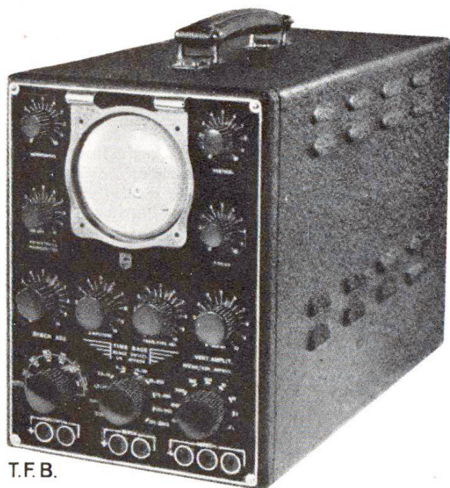
Fig. 6 Oscillographe à rayons cathodiques (Philips) pour la mise en évidence et la mesure des vibrations. Par la méthode électrique, on peut comme dans les récepteurs de radio, amplifier à volonté les phénomènes à observer
