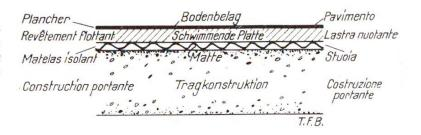
Une autre avantage indirect des constructions massives réside dans le fait qu'il est plus facile, donc moins coûteux, d'y appliquer un revêtement isolant quand il le faut. Une telle isolation supplémentaire peut être rendue nécessaire lors de l'installation d'une industrie, d'une mécanisation de certains travaux de bureau ou de la division d'un grand logement en d'autres plus petits, etc.
