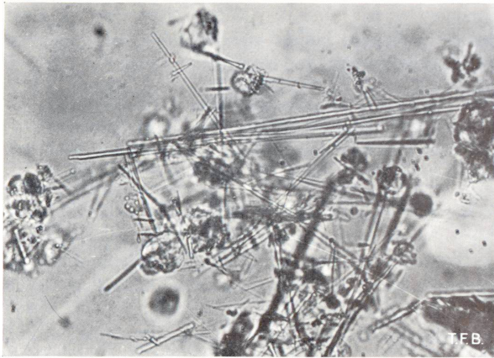
Fig. 5 Microphotographie montrant les longues aiguilles des aluminates, des sulfoaluminates et des ferroaluminates formés après 3 ans de durcissement d'un ciment (grossissement 580 fois)
