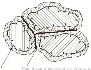
Fig. 3 Durcissement du gel: Pénétration de l'eau à l'intérieur des grains et formation d'un mince film d'eau, siège des forces de cohésion
