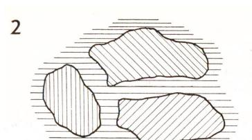
Fig. 1 Les grains de ciment en contact avec l'eau
