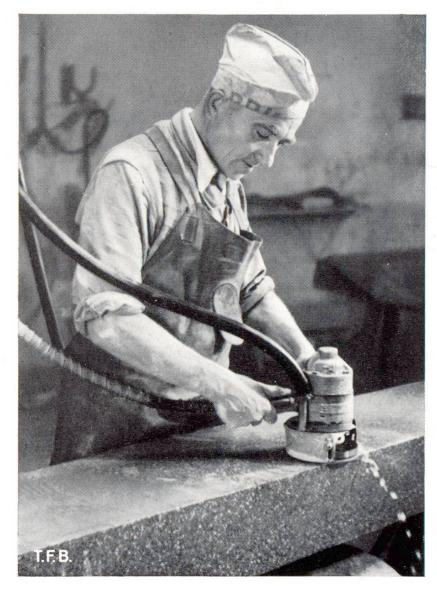
Fig. 2 Machine portative en service. Elle est actionnée et alimentée en eau par un flexible
