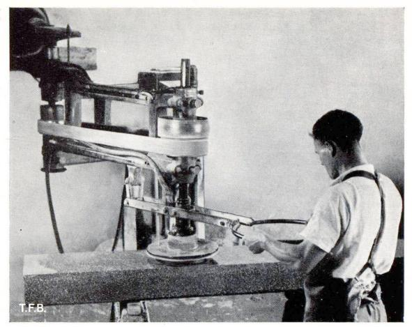
Fig. 5 Polissage au moyen d'une machine à hauteur réglable fixée sur un bras mobile
