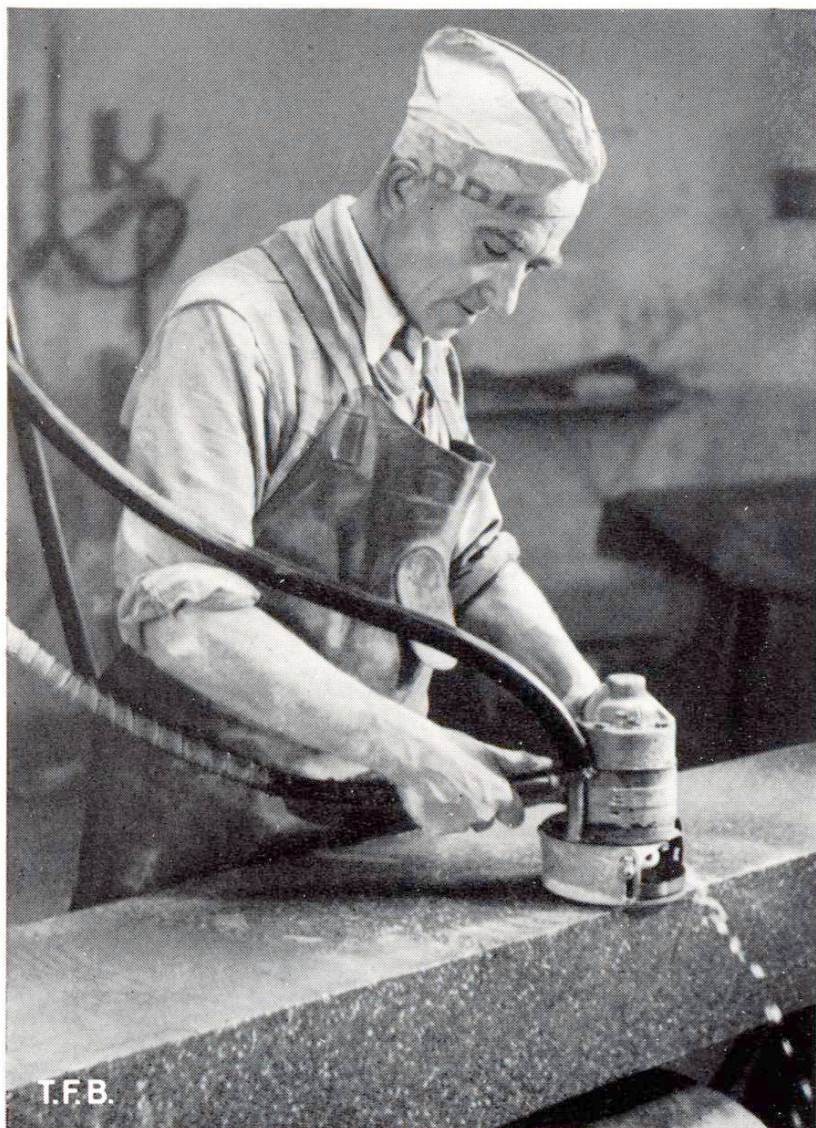
Fig. 2 Machine portable en service. Elle est actionnée et alimentée en eau par un flexible
