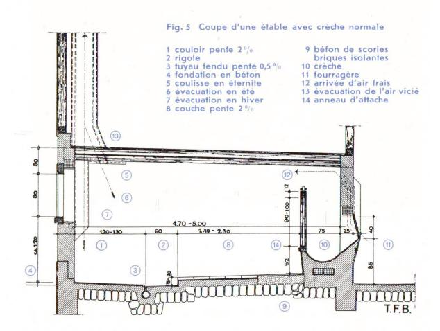
Dans les constructions agricoles, les **parois** sont élevées en béton dès la fondation et jusqu'au niveau que peut atteindre l'humidité de la pluie et de la neige. Ces parois en béton doivent être isolées à l'intérieur pour éviter l'eau de condensation. Il faut prévoir la même isolation contre les linteaux en béton des portes et fenêtres.
