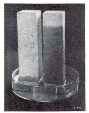
Fig. 3 Deux échantillons différents de béton perméable. Des canaux capillaires ouverts et très fins font monter l'eau par capillarité
