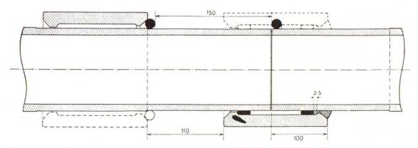
Fig. 6 Joint Simplex, en haut: au début du montage, en bas: montage achevé
