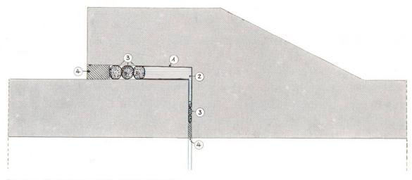
Fig. 3 a Emboîtement à cloche simple
