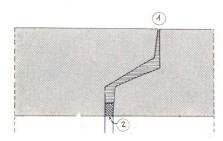
Fig. 1b Emboîtement normal Diamètre supérfeur à 50 cm
