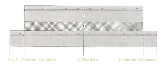
Pour colmater ce joint, on utilise en général un bon mortier de ciment et de sable lavé dans la proportion 1:1½ à 1:2. La consistance du mortier doit être pâteuse, mais en aucun cas trop sèche ou trop humide. Après un badigeonnage au lait de ciment, on enduit de mortier la partie inférieure du bout femelle déjà posé et la partie supérieure du bout mâle du nouveau tuyau qu'on
