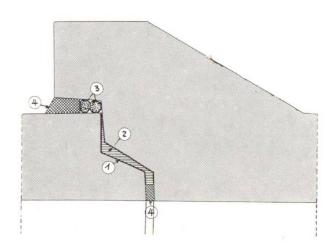
Fig. 3 b Emboîtement à cloche à double épaulement
