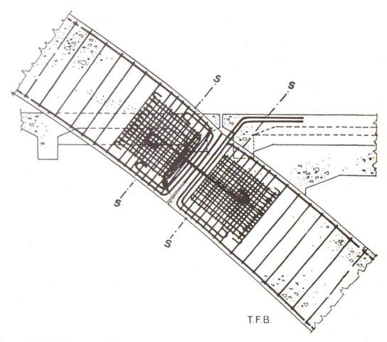
Fig. 1 Articulation à roulement, en béton armé, à la naissance d'une voûte à 3 articulations (tablier suspendu). Pont de Lindóia sur le Rio do Peixe, Brésil. (Boletim No. 22 de l'Inst. de Pesqu. Techn. de Sao Paolo)
