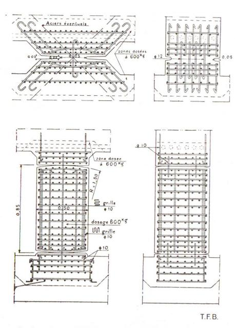
Fig. 5 Appareils d'appui normalisés des chemins de fer français (SNCF) pour les pontspoutres en béton armé des passages supérieurs de plus de 20 m de portée. Exécution en béton armé calculée pour une réaction de 250 t. En-haut, appui fixe; en-bas, appui mobile (pendulaire). (Travaux No. 160)
