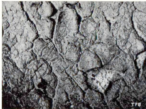
Fig. 4 Décomposition d'une peinture à l'huile appliquée sur une surface en ciment trop fraîche et non traitée
