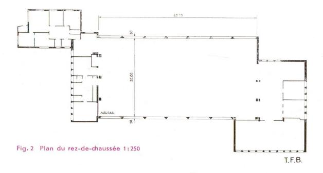
constitués par des fers profilés tandis que le plancher se compose de solives en béton armé préfabriquées et de hourdis en ciment. Ce plancher a été calculé et exécuté comme dalle continue pour une **surcharge de 500 kg/m².** Les portées respectives sont de 4.44, 5.56, 5.56, 4.44 m. Dans la région des moments négatifs aux appuis, on a également posé des dalles spéciales en
