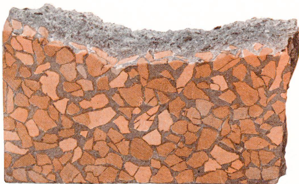
Fig. 4 Coupe à travers un carreau de terrazzo coloré
