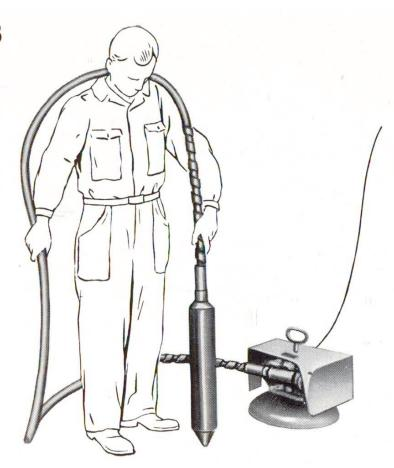
2. La **vibration superficielle**, dans laquelle le vibrateur est posé sur la surface de béton et déplacé à intervalles réguliers. Emploi de poutres ou plaques sur lesquels les vibrateurs sont fixés. Applications: revêtements minces, planchers, voiles.
