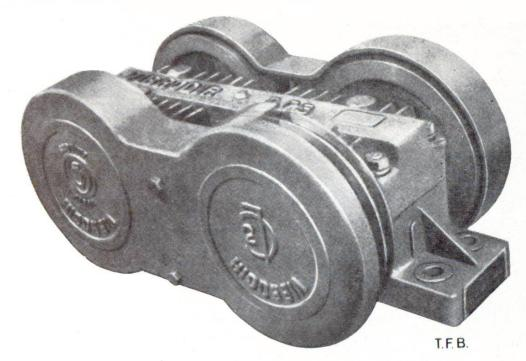
Fig. 6 Vibrateur électrique de coffrage. Force centrifuge 6 t. Ce modèle a été employé pour l'exécution des éléments précontraints du pont de Luzancy (France)
