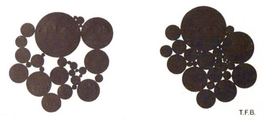
Fig. 1 Représentation schématique de l'effet de la vibration A gauche: avant à droite: après la vibration
