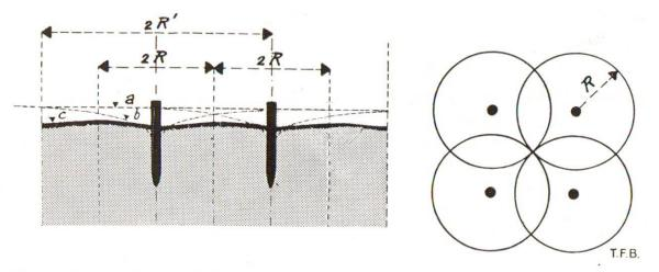
Fig. 3 Schéma de travail d'un vibrateur à aiguille
