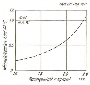
Fig. 1 Rapport entre le coefficient de conduction thermique à et la densité apparente du béton
