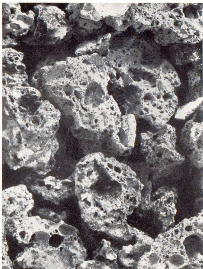
Fig. 2 Scorie de haut-fourneau gonflée servant d'agrégat léger
