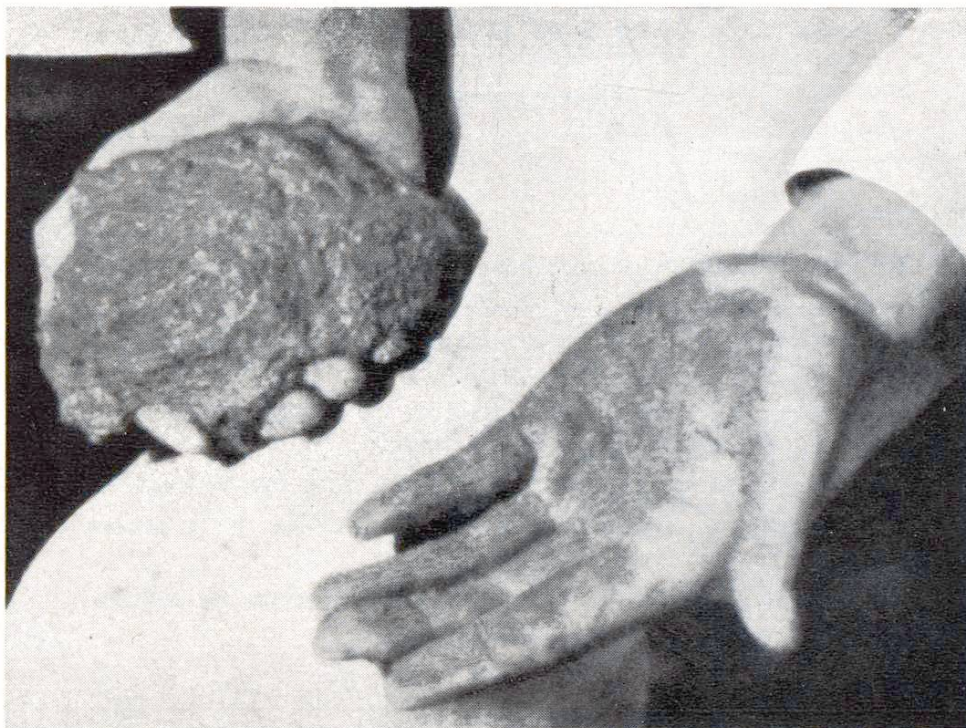
Fig. 2 Essai à la main: la capacité de déformation (plasticité), le pouvoir collant, etc. peuvent être facilement jugés. Avec le béton «terre humide», on doit encore tout juste pouvoir faire une boule, mais celle-ci se désagrège déjà sous une légère pression. Le béton plastique doit se comporter comme une pâte modelable
