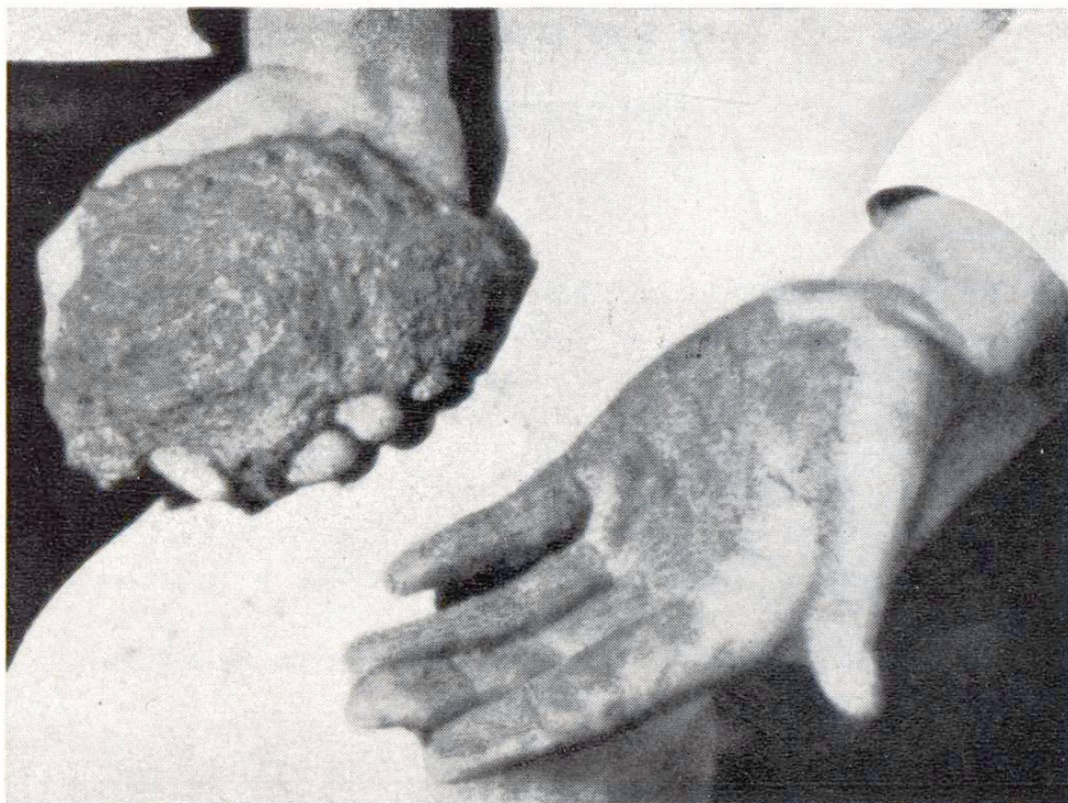
Fig. 2 Essai à la main: la capacité de déformation (plasticité), le pouvoir collant, etc. peuvent être facilement jugés. Avec le béton «terre humide», on doit encore tout juste pouvoir faire une boule, mais celle-ci se désagrége déjà sous une légère pression. Le béton plastique doit se comporter comme une pâte modelable
