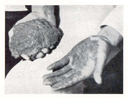
Fig. 2 Essai à la main: la capacité de déformation (plasticité), le pouvoir collant, etc. peuvent être facilement jugés. Avec le béton «terre humide», on doit encore tout juste pouvoir faire une boule, mais celle-ci se désagrège déjà sous une légère pression. Le béton plastique doit se comporter comme une pâte modelable
