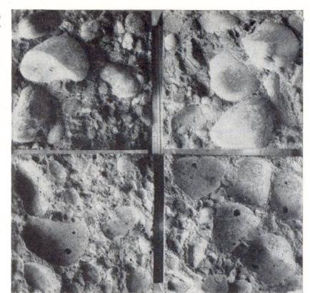
Fig. 1 Effet de la remontée d'eau sur la cassure horizontale par flexion de deux prismes fabriqués en position verticale
