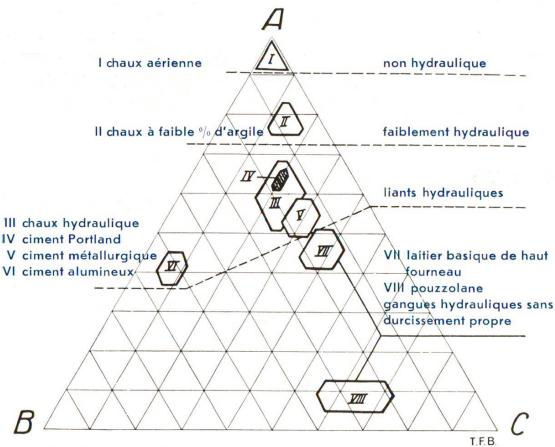
Fig. 2 Les liants dans le système ternaire. Diagramme triangulaire avec la chaux ( $A = 100^{\circ}/_{\circ}$ ), l'alumine ( $B = 100^{\circ}/_{\circ}$ ) et la silice ( $C = 100^{\circ}/_{\circ}$ )
