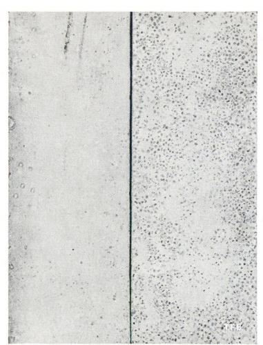
Fig. 4 Essai d'arrosage avec de l'eau de pluie sur les mortiers de ciment Portland 1:3. A gauche, sans arrosage. A droit, après l'effet d'un arrosage correspondant à une quantité de pluie tombée en
