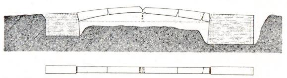
Fig. 3 Elévation et plan de la voûte au moment où le voussoir de clef était entièremen détruit
