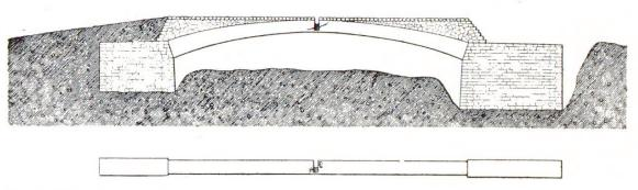
Fig. 2 Elévation et plan de la voûte au moment oû le voussoir de clef était réduit à une épaisseur et une longueur minima
