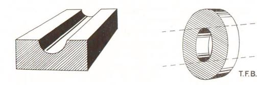
Fig. 4 Support d'écartement servant à assurer une épaisseur de recouvrement suffisante
