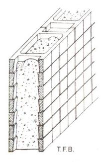
L'érection de cheminées en pièces détachées se montre avantageuse car elle accélère beaucoup le travail. Il faut que les éléments soient imperméables aux gaz de combustion et qu'ils résistent à leur agressivité. Les gaz ne doivent pas se refroidir trop rapidement (goudronnage des cheminées, tirage). Ces exigences sont satisfaites au mieux par les pièces moulées monolithiques en béton de débris de terre cuite, qui permettent une exécution rapide, avec peu de joints, des canaux de fumée.
