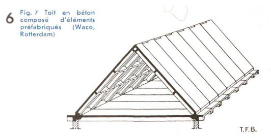
poutres préfabriquées en béton armé de qualité supérieure (haute résistance, sections réduites, faibles poids) permet d'entrevoir l'écoulement économique de poutraisons en béton armé résistant au feu.
