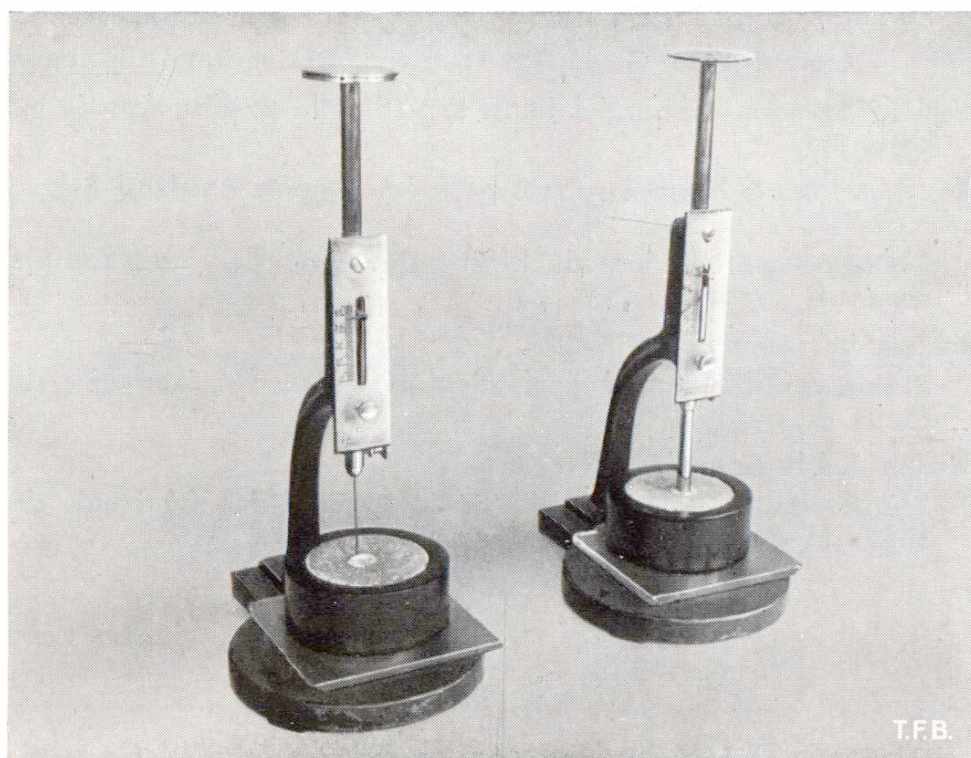
Fig. 2 Appareil de Vicat. A droite avec dispositif pour mesurer la consistance de la pâte de ciment à examiner. A gauche avec l'aiguille de 1 mm 2 de section servant à déterminer les temps de prise
