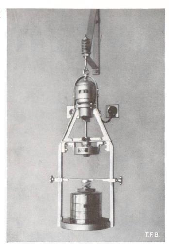
Fig. 1 Tamis mécanique pour déterminer la finesse de mouture des liants. Le résidu sur le tamis moyen de 4900 mailles/cm² ne doit pas dépasser 10 %
