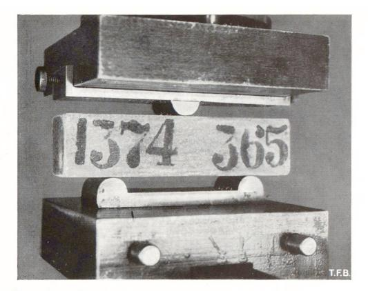
Fig. 4 Prisme de mortier normal (4×4×16 cm) soumis à l'essai de flexion. Après la rupture du prisme, les deux moitiés restantes sont encore soumises à l'essai de résistance à la compression
