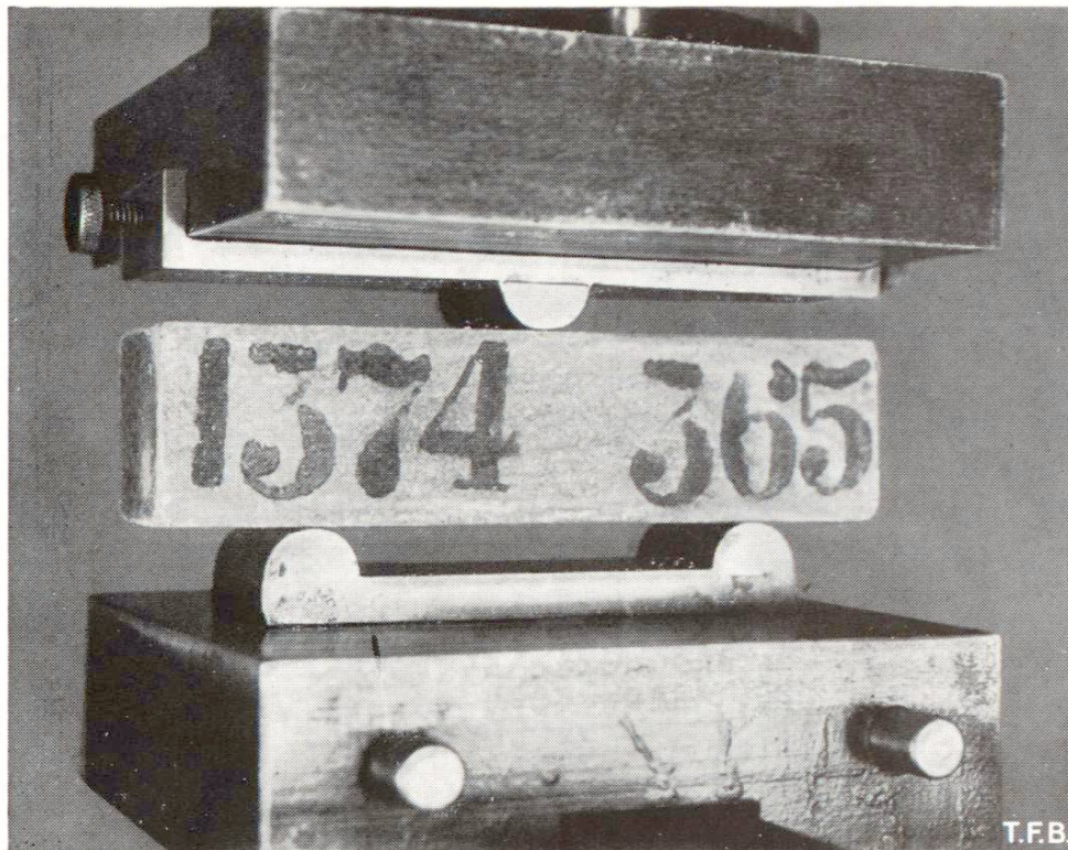
Fig. 4 Prisme de mortier normal ( 4 \times 4 \times 16 cm) soumis à l'essai de flexion. Après la rupture du prisme, les deux moitiés restantes sont encore soumises à l'essai de résistance à la compression
