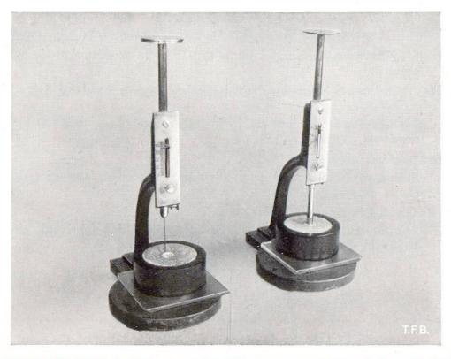
Fig. 2 Appareil de Vicat. A droite avec dispositif pour mesurer la consistance de la pâte de ciment à examiner. A gauche àvec l'aiguille de 1 mm² de section servant à déterminer les temps de prise
