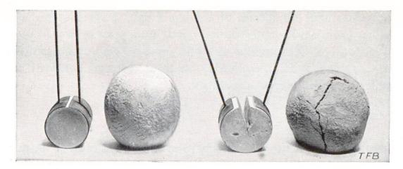
Fig. 3 Essai de la stabilité de volume. A gauche, ciment stable; à droite, liant expansif
