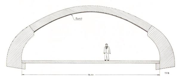
Fig. 5 Etanchement du plafond d'un abri de D. A. P.
