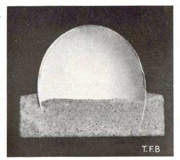
Fig. 1 Coupe à travers une coquille d'œuf sur berceau. Epaisseur de la coquille 0,34 mm, portée ~ 40 mm. Avec ce dispositif d'essai, la coquille supporte une charge unique de 3,5 kg appliquée au sommet.
