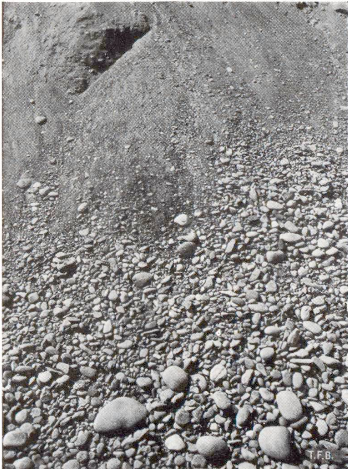
Fig. 1 Séparation dans un dépôt de ballast
